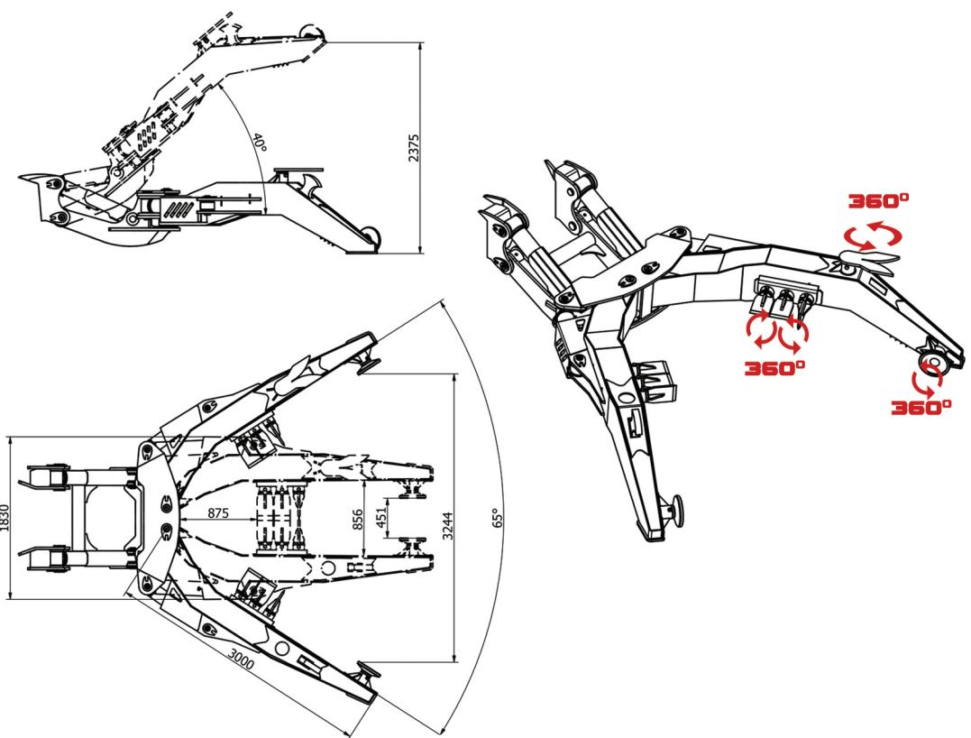
Przystawka do recyklingu pojazdów (samochody, auto dostawcze oraz ciężarowe). Urządzenie posiada funkcję: dociskania / unoszenia, cięcia, ściągacza do opon, ściągacza do wiązek elektrycznych samochodowych.
